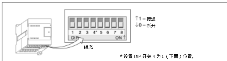
图 31 组态 EM231 热电偶模块的 DIP 开关
