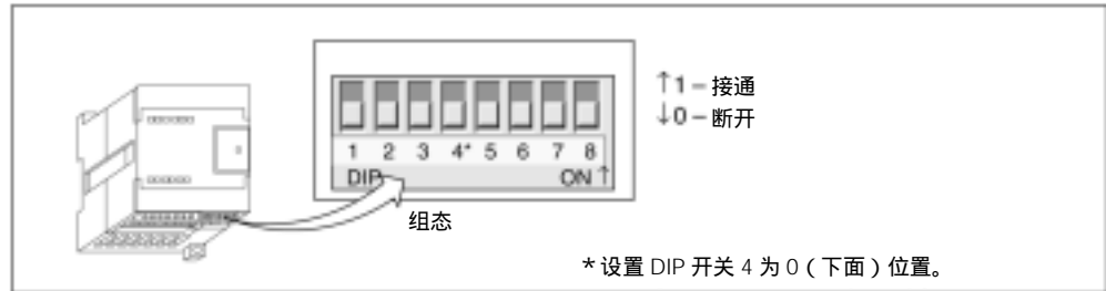
图 32 组态热电阻模块的 DIP 开关。
